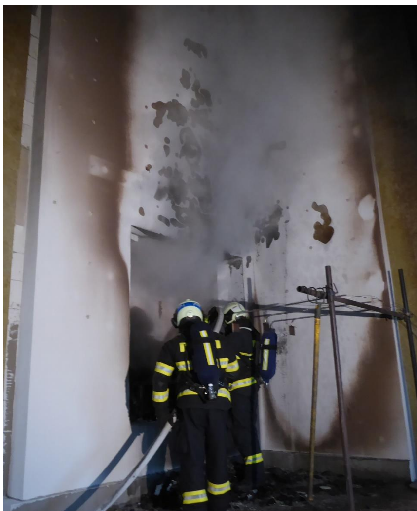
Dohašení hranice a oblasti pruhu z minerální vlny po 60 minutách zkoušky
