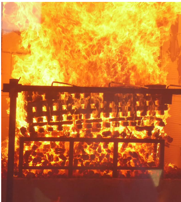
Bortfcí se hranice dřeva po 24 minutách zkoušky
