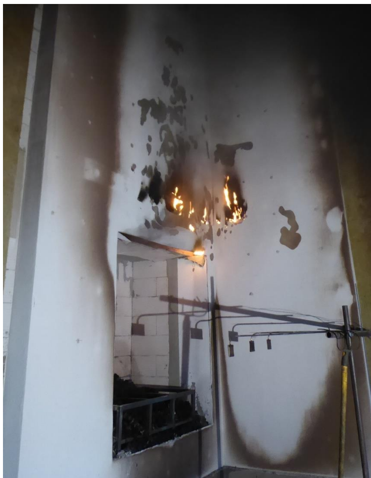
Vzorek po uhašení hranice dřeva, mírné hoření v místě požárního pruhu
