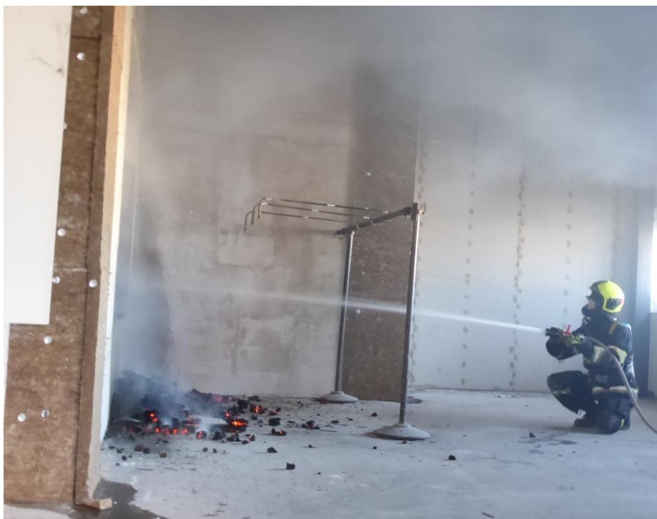
Hašení hranice dřeva po 30 minutách zkoušky
