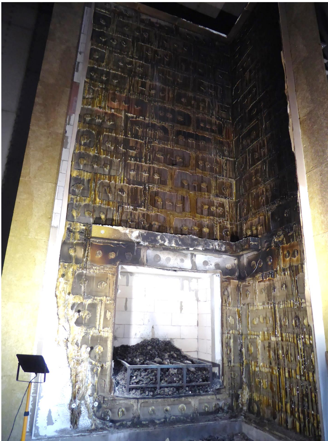
Vzorek druhý den po zkoušce, po odstranění vnějšího souvrství
