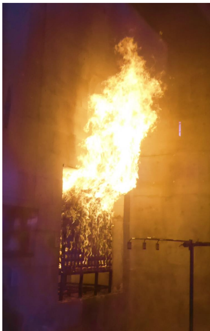
Hranice dřeva a podpěrná konstrukce po 15 minutách zkoušky
