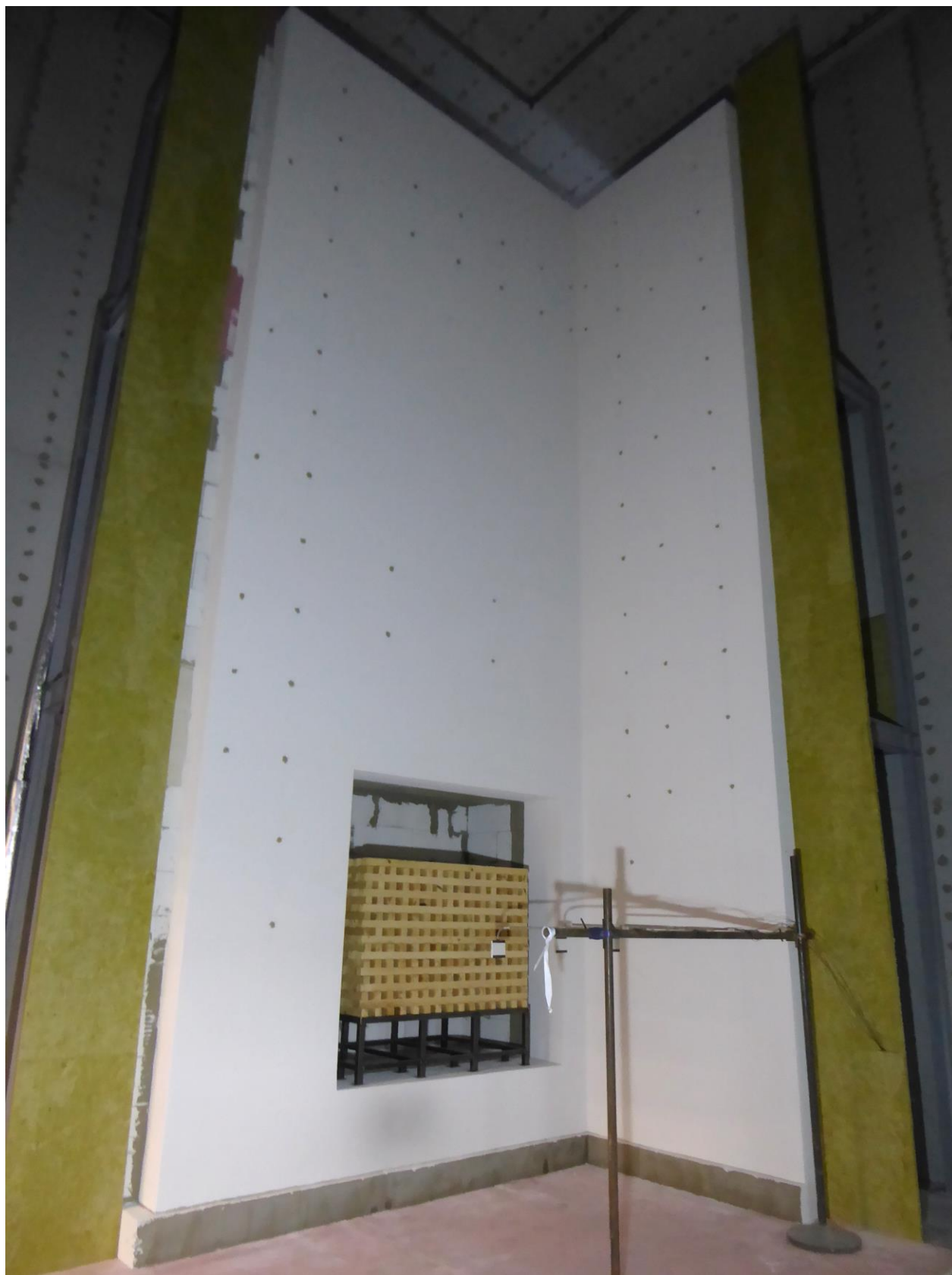
Vzorek před zahájením zkoušky s rozmístěním termočlánků
