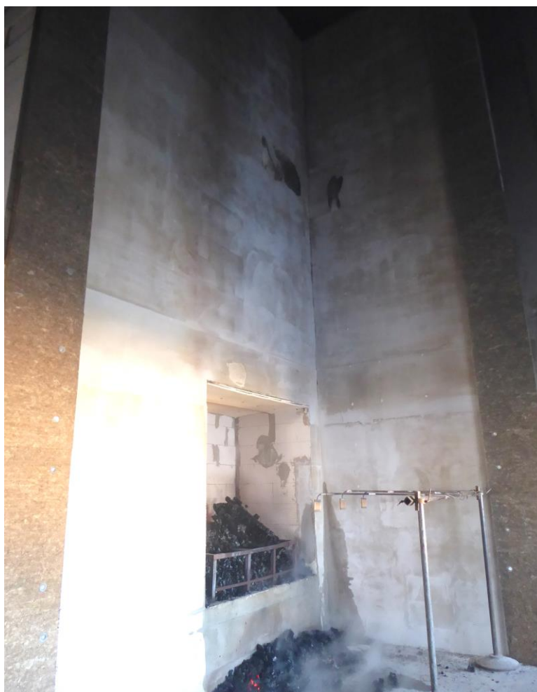
Podpěrná konstrukce po uhašení hranice dřeva
