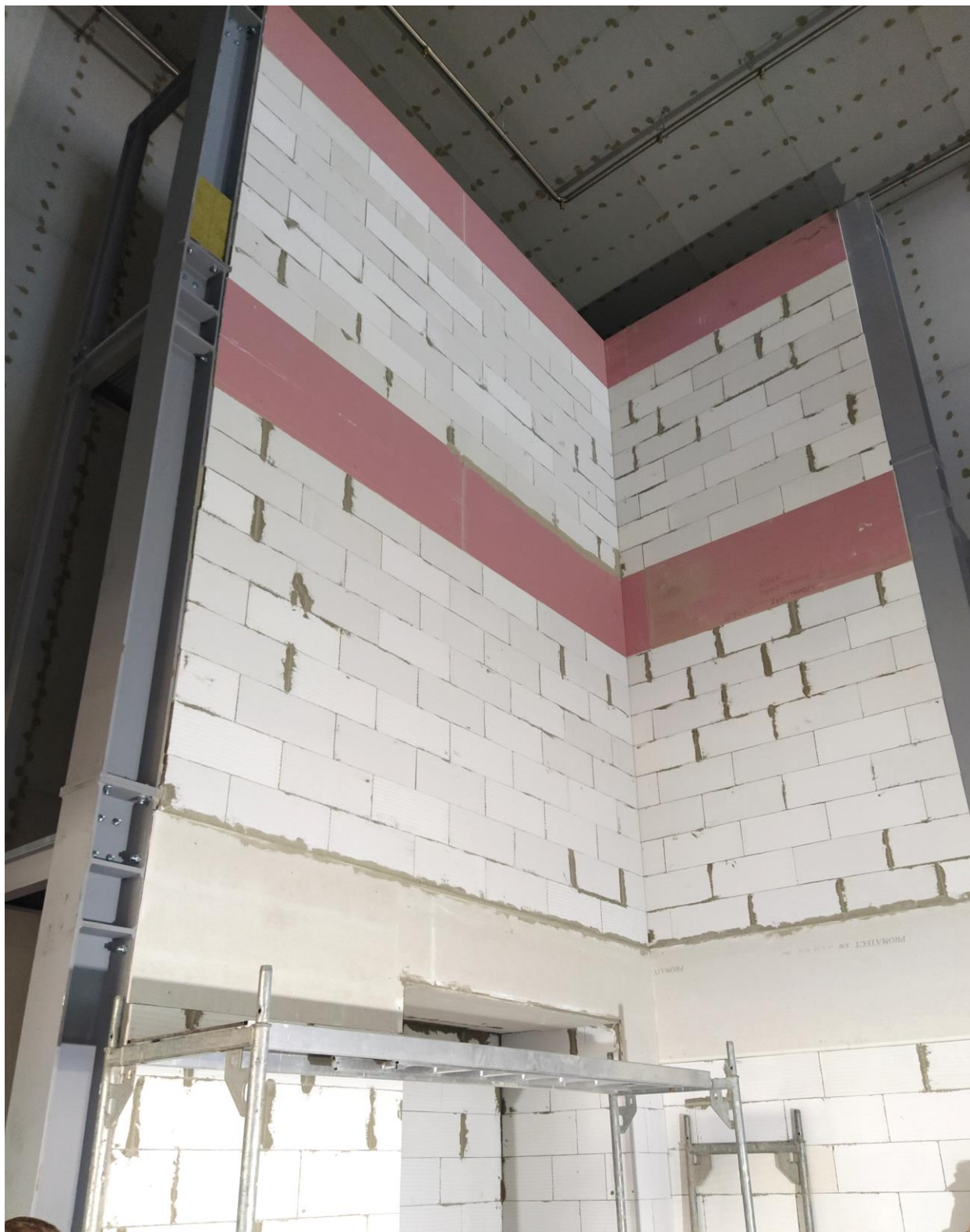
Podpěrná konstrukce před montáží vzorku
