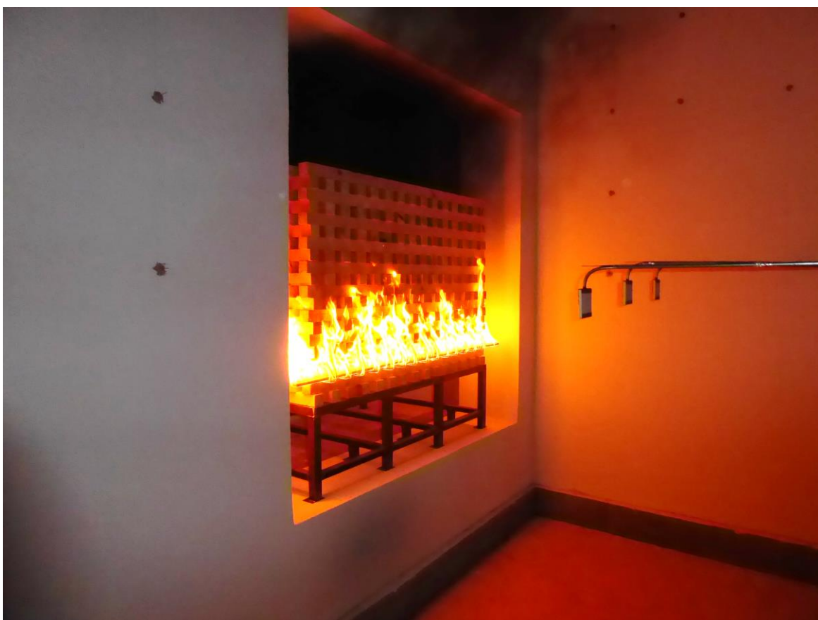
Hranice dřeva před zkouškou a po jejím zapálení
