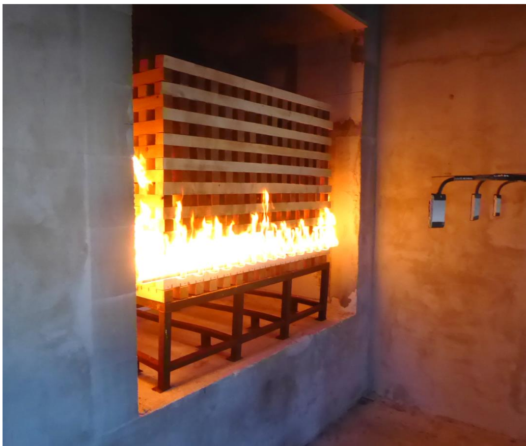
Hranice dřeva před zkouškou a po jejím zapálení
